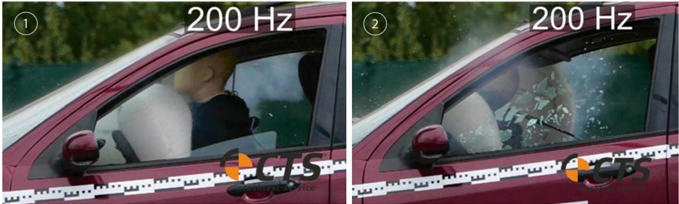
**BILD 18:** Brustanprall des nicht angegurten Insassen gegen den Airbag (1) und auf das Lenkrad (2)
