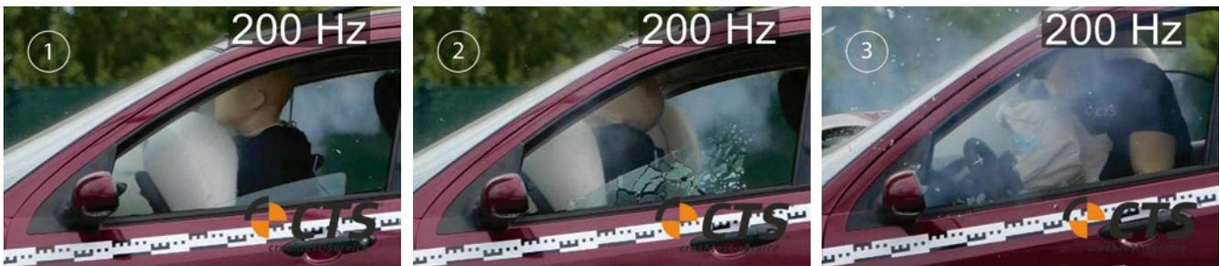
**BILD 9:** Mehrfacher Kopfanprall des nicht angegurten Insassen an die Dachkante (1), die Scheibe (2) und den Dachhimmel (3)
