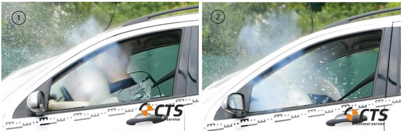
**BILD 11:** Kopfanprall des schlecht angegurten Insassen gegen den Airbag (1) und auf das Lenkrad (2)
