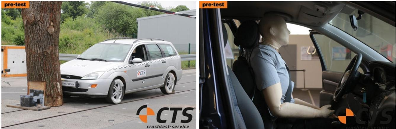
**BILD 2:** Anstoßkonfiguration der Versuchsreihe beim frontalen Baumanprall mit 40% Überdeckung (links) und verwendetem PRIMUS-Dummy im Fahrzeug (rechts)
