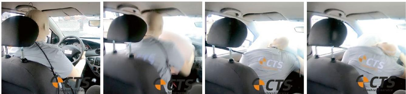
BILD 15: Erhebliche Kopfverdrrehung beim Eintauchen in den Airbag (gut angegurter Insasse)
