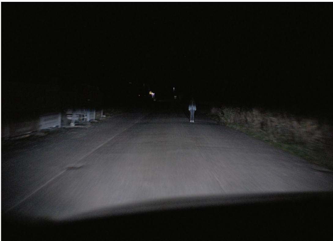
BILD 18: Sichtaufnahme während der Fahrt; Abblendlicht, Belichtung 1/20 s, Blende F/2.2, ISO-1600
