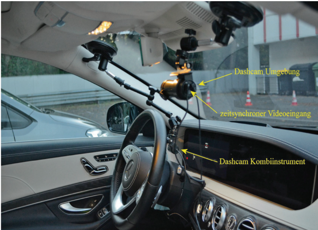
BILD 16: Versuchsaufbau zur Bestimmung der Geschwindigkeitsschwelle beim Mercedes FIGURE 16: Test setup for determining the speed threshold on the Mercedes
