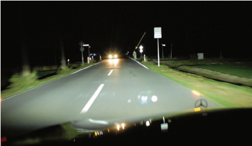
BILD 30: Sichtfoto bei Annäherung an den Fußgänger mit teilausgeblendetem Fernlicht aufgrund von Gegenverkehr
