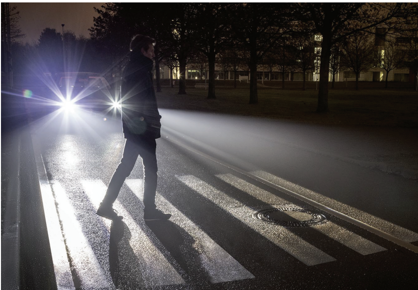
BILD 2: Projektion von Hinweisen für Fußgänger auf die Fahrbahn FIGURE 2: Projection of signs for pedestrians onto the road
