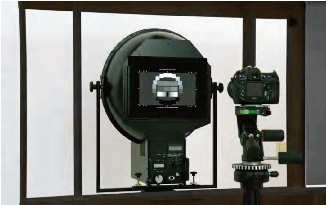
BILD 9: Kamera bei der Kalibrierung mit einer Ulbrichtkugel FIGURE 9: Camera calibrated with an Ulbrichtkugel
