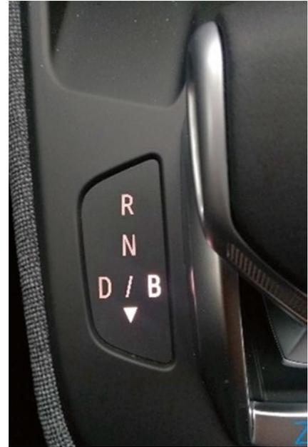
**BILD 3:** Betriebsmodi am Wählhebel des Renault Zoe PH2
