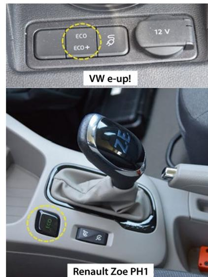
BILD 5: Taste zur Aktivierung des ECO-Modus im VW e-up! (oben) und Renault Zoe PH1 (unten)
