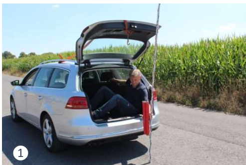
Abb. 3: Versuchsanordnung (1), Auftreffen der Rohre auf der Fahrbahn (2) und zwischenzeitliche Sprunghöhe nach dem ersten Lösen von der Fahrbahn (3)
