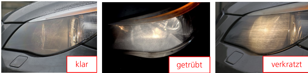
Abb. 1: Darstellung der unterschiedlich beschädigten Scheinwerfer am BMW E60
