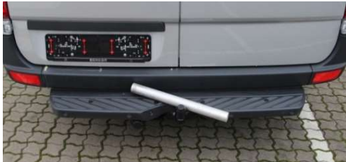
Abb. 1: Verklemmen des Metallrohres am VW Crafter
