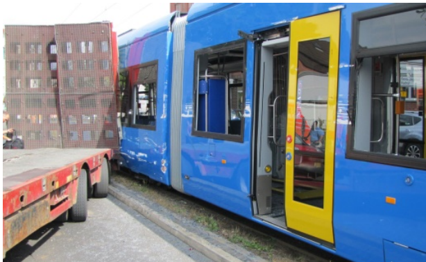
Abb. 1: Heck des Aufliegers ist in den Fahrbereich der Straßenbahn hineingeschwenkt
