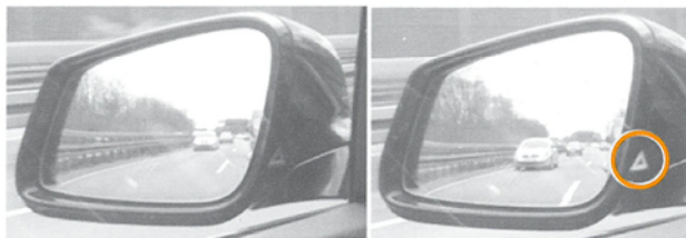
Abb. 2: optische Warnung im Außenspiegel beim Spurwechselassistenten
