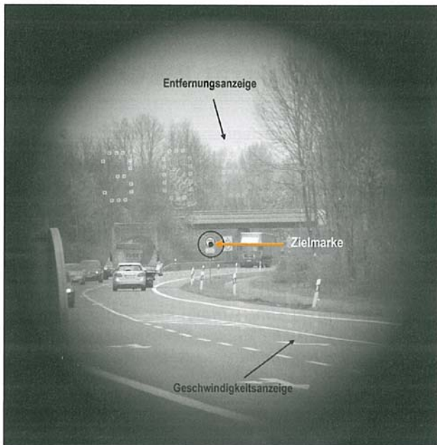
Abb. 2: Nullmessung an einem Verkehrsschild in 306,9 m Entfernung
