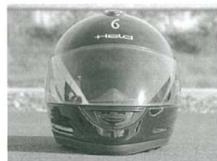
a) Stirnbereich (kein Schaden)
