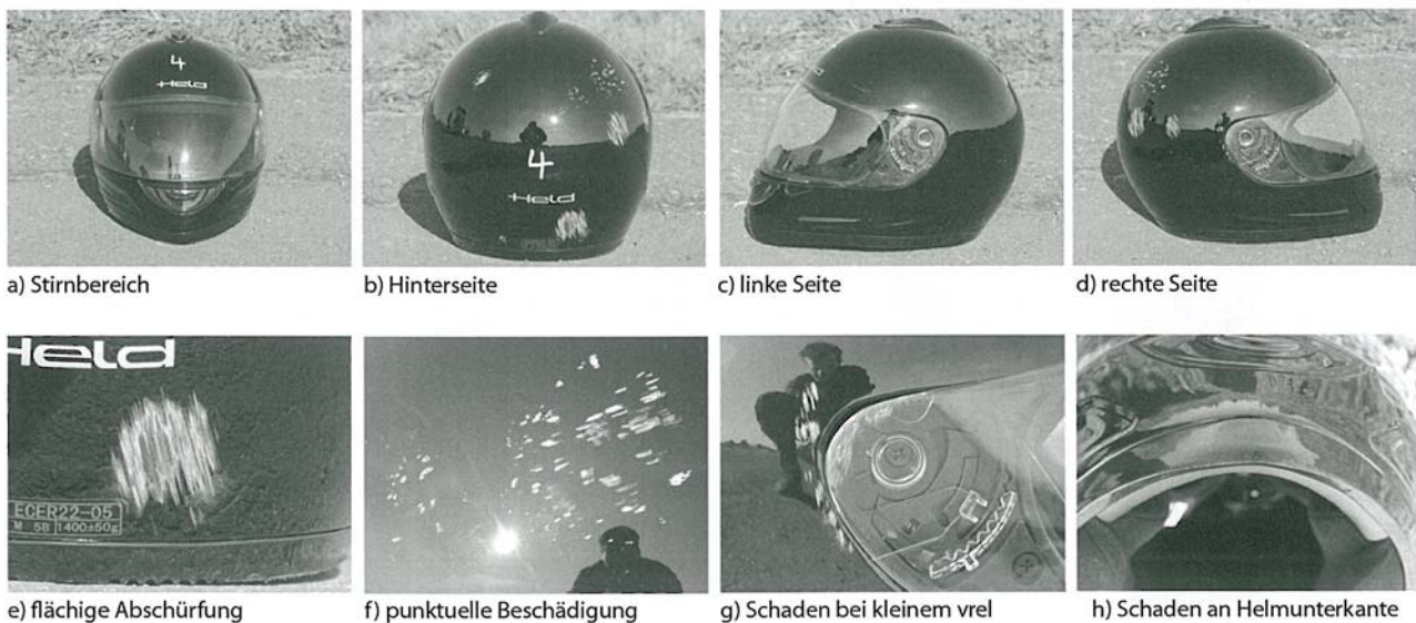
Abb. 4: Helm Nr. 4 nach dem Versuch (ohne Dummy)
