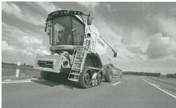
Abb. 2: Mähdrescher mit Raupenfahrwerk (zulässige Geschwindigkeit: 40 km/h, Leergewicht: 17 t, Breite: mind. 3,29 m) (Quelle: Claas)
