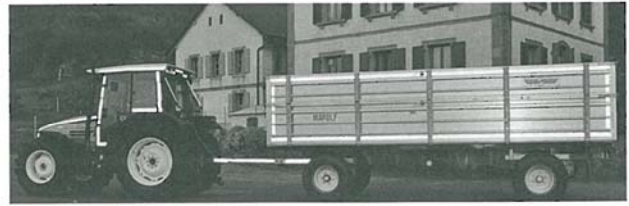
Abb. 4: Traktorgespann mit reflektierender Konturmarkierungsfolie (Quelle: www.bul.ch )
