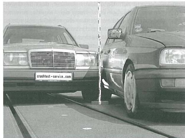
Abb. 10: Versuch – Mercedes fährt in stehenden VW
