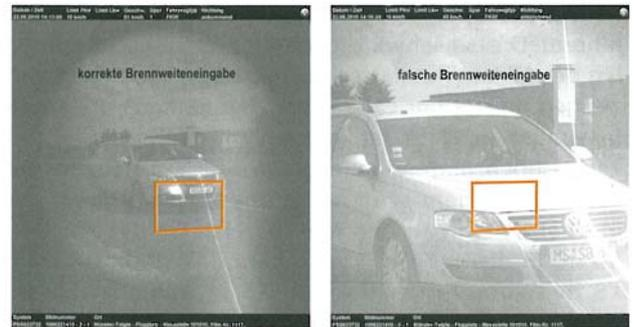
Abb. 49: Messfotos rechte Fahrspur (falsche Eingabe Objektivbrennweite)
