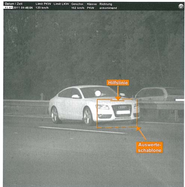
Abb. 2: Messfoto mit Auswerteschablone
