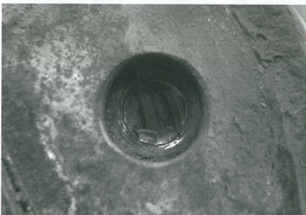
Abb. 1: Radnabe mit abgebrochenen Radbolzen in den Schraublöchern
