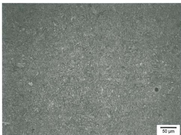
Abb. 4: Gefügeaufnahme der inneren Struktur eines Radbolzens: Hier sind keine Fehlstellen vorhanden.
