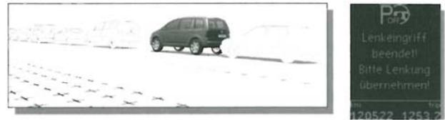
Abb. 9 Abschluss des Einparkvorganges mit Übergabe an den Fahrer
