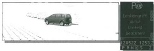
Abb. 8 Automatischer Lenkvorgang mit Fahrerwarnung
