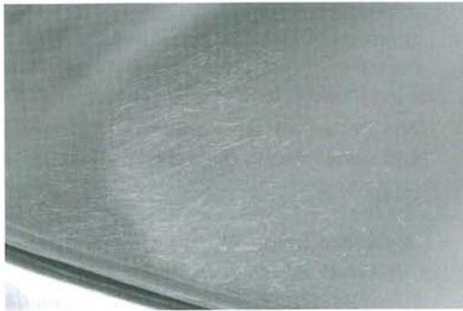
Abb. 7 Charakteristische Kratzspuren durch Sturz im Kiesbett
