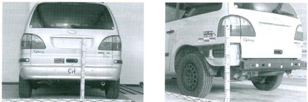
Bild 4: Beschädigungen Ford Galaxy (Quelle: [www.agu.ch](http://www.agu.ch))
