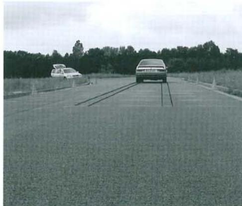
Abb. 8: BMW 628 mit 60 km/h und  $a^m = 9,6 \text{ m/s}^2$
