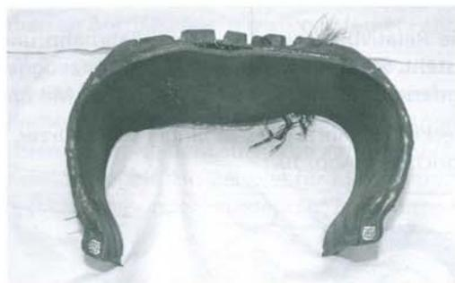
Abb. 7: Reifenquerschnitt
