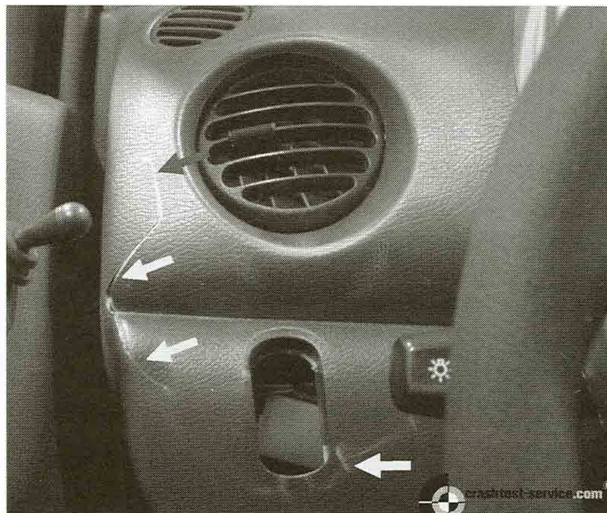
Abb. 10: Massiver Knieanprall mit Zerstörungen am Armaturenbrett (Crashversuch CTS, www.crashtest-service.com )
