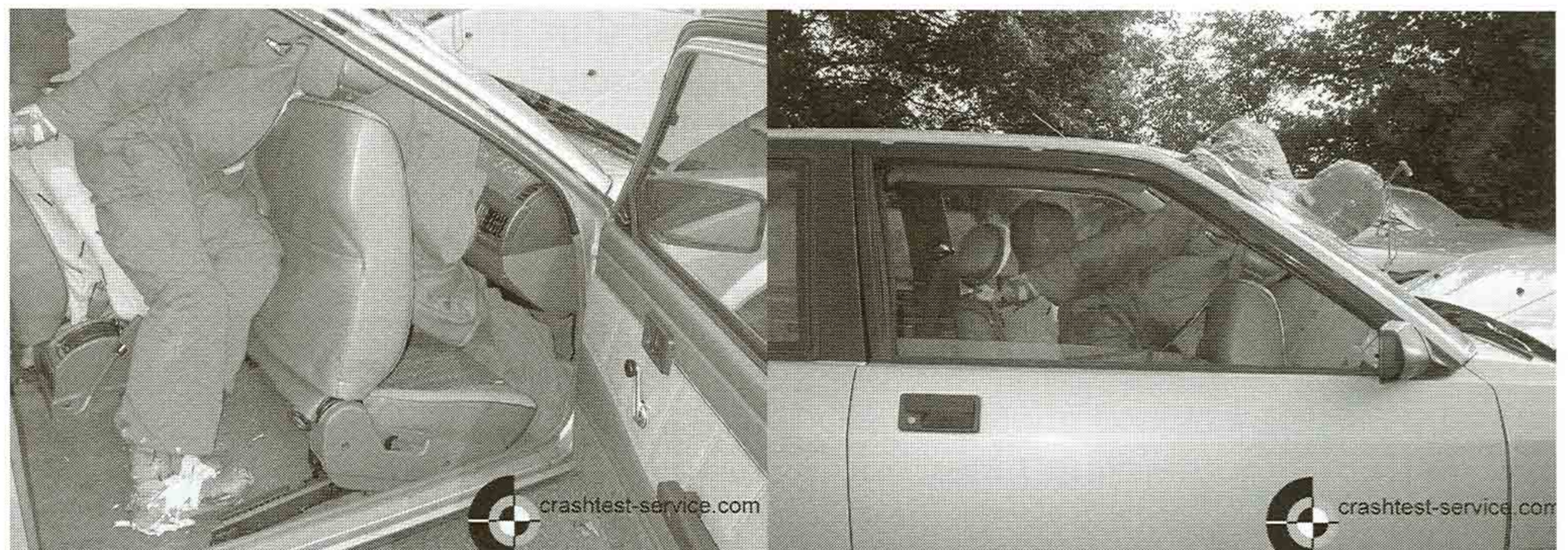
Abb. 11: Nicht gurtgesicherter, hinten rechts sitzender Dummy drückt Beifahrersitz nach vorn (delta v = ca. 55 km/h; Crashversuch CTS, www.crashtest-service.com )
