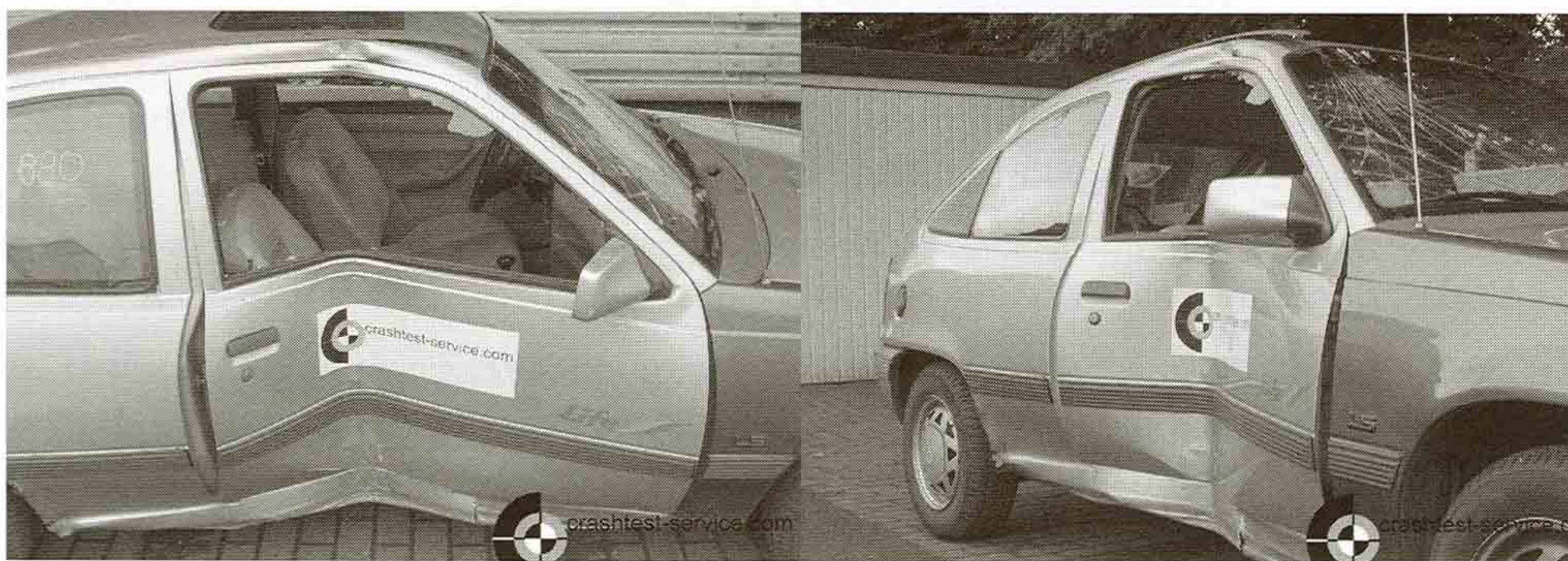
Abb. 5: Intrusion der Fahrgastzelle beim seitlichen Baumanprall (Crashversuch CTS, www.crashtest-service.com )
