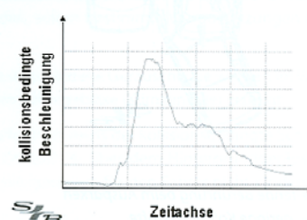
Versuch 2: Anprall gegen „B“-Säule
