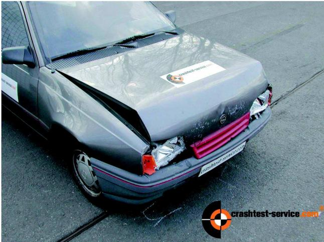
**BILD 1:** Opel Kadett,  $v=22,9$  km/h,  $EES=22,6$  km/h,  $m=991$  kg,  $E_{def}=19.527$  Nm ([4]: 11927)
