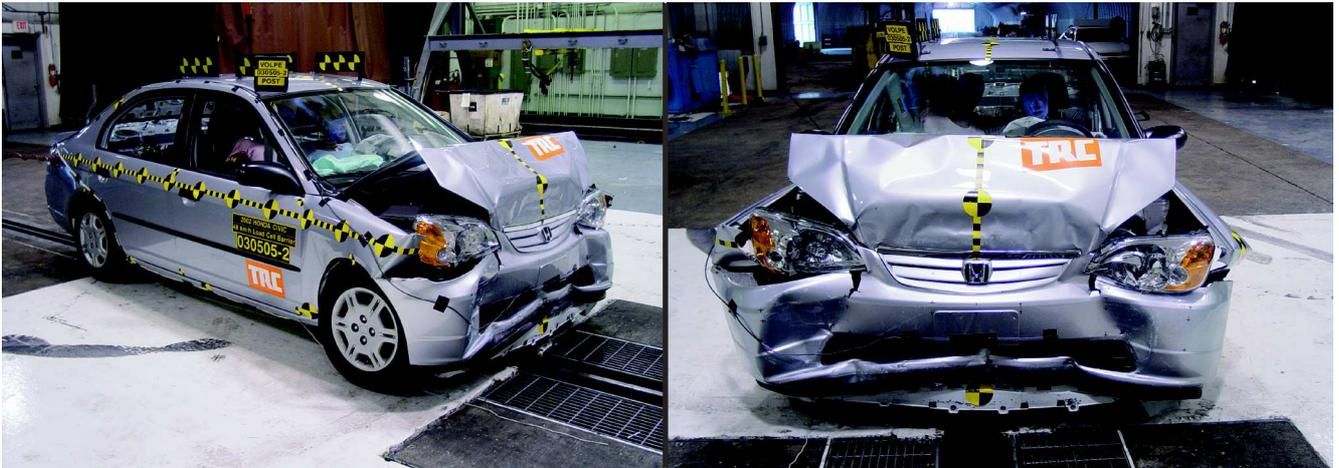
**BILD 12 und BILD 13:** Honda Civic (Modell 2002) nach Barrierenanprall (FMVSS 208, 48,2 km/h), maximale statische Verformung 372 mm,  $a_{\text{mittel}} = 16 \text{ g}$ ,  $a_{\text{max}} = \text{circa } 30 \text{ g}$ ,  $m = 1325 \text{ kg}$  [8]
