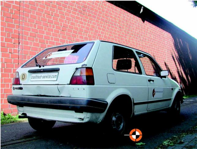
**BILD 3:** Versuch 1, VW Golf,  $v=7,9$  km/h,  $EES=7,6$  km/h,  $m=896$  kg,  $E_{def}=1996$  Nm ([4]: 11025)
