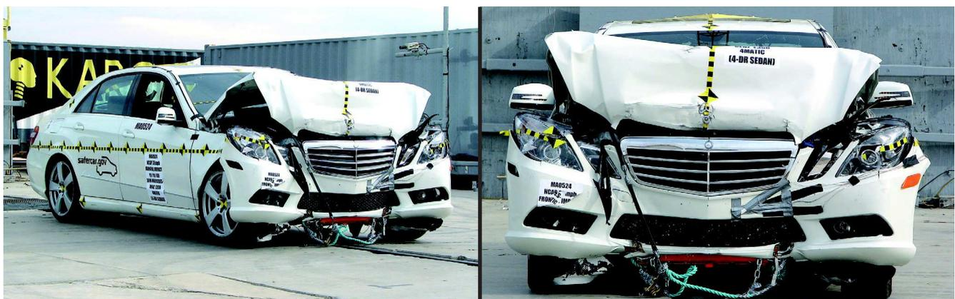
BILD 16 und BILD 17: Mercedes-Benz E350 4Matic (Modell 2010) nach Barrierenanprall (FMVSS 208, 56,3 km/h), maximale statische Verformung 480 mm,  $a_{\text{mittel}}=23 \text{ g}$ ,  $a_{\text{max}}=\text{circa } 57 \text{ g}$ ,  $m=2084 \text{ kg}$  [8]
