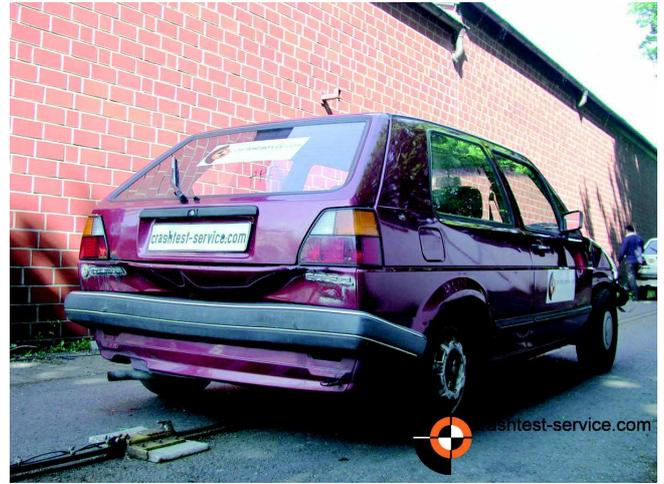
**BILD 4:** Versuch 2, VW Golf,  $v=8,1$  km/h,  $EES=7,9$  km/h,  $m=1208$  kg,  $E_{def}=2908$  Nm ([4]: 11026)
