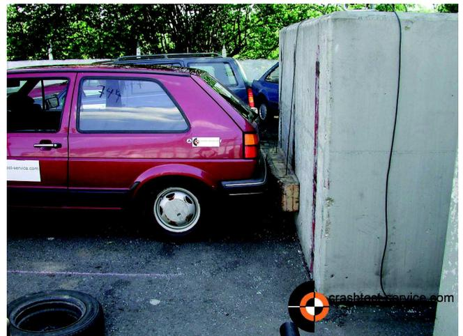
**BILD 6:** Versuch 2, Anstoßkonfiguration 100%, 0°
