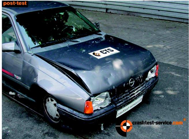
**BILD 2:** Opel Kadett,  $v=19,3$  km/h,  $EES=19,1$  km/h,  $m=1406$  kg,  $E_{def}=19.788$  Nm ([4]: 15007)
