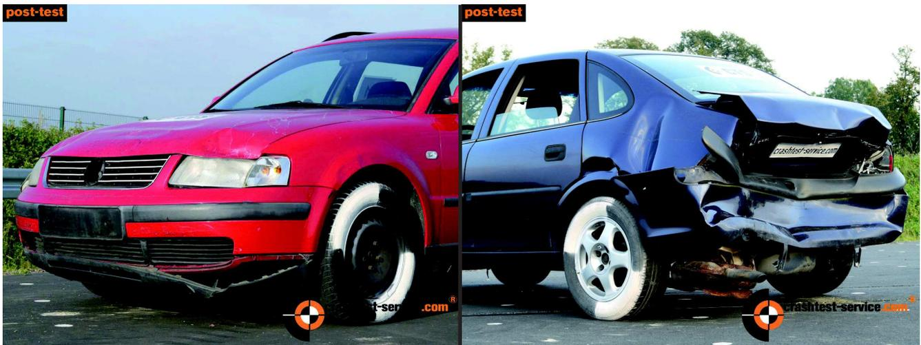
**BILD 24:** Volkswagen Passat ( $m=1440$  kg) und **BILD 25:** Opel Vectra ( $m=1685$  kg);  $v=41,8$  km/h,  $k=0,14$ ;
