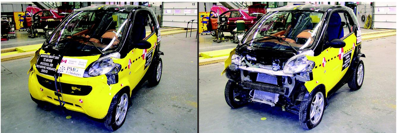
BILD 10 und BILD 11: MCC Smart (Modell 2000) nach Barrierenanprall (CMVSS/NSVAC 208, 48,0 km/h), maximale statische Verformung 217 mm,  $a_{\text{mittel}}=23\text{ g}$ ,  $a_{\text{max}}=\text{circa } 64\text{ g}$ ,  $m=992\text{ kg}$  [8]
