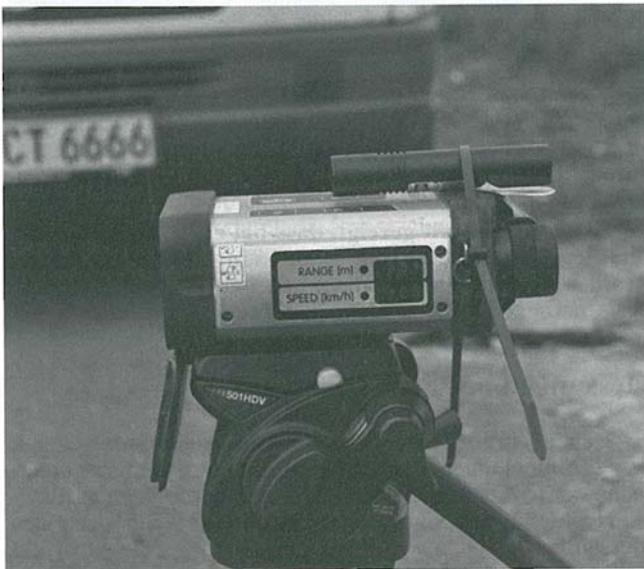
Abbildung 10: Messung über Pkw-Scheibe bei sich näherndem Pkw (35,4 km/h bei 25 m)
