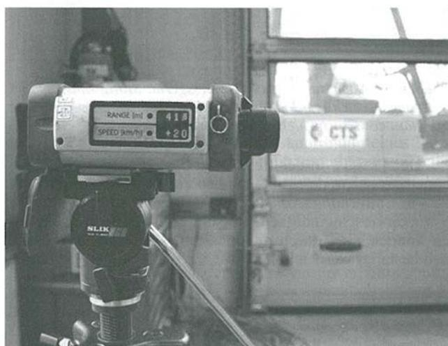
Abbildung 7: Die Messung zeigt die Geschwindigkeit des sich unter 90° nähernden und nur über die verspiegelten Scheiben zu messenden Pkw
