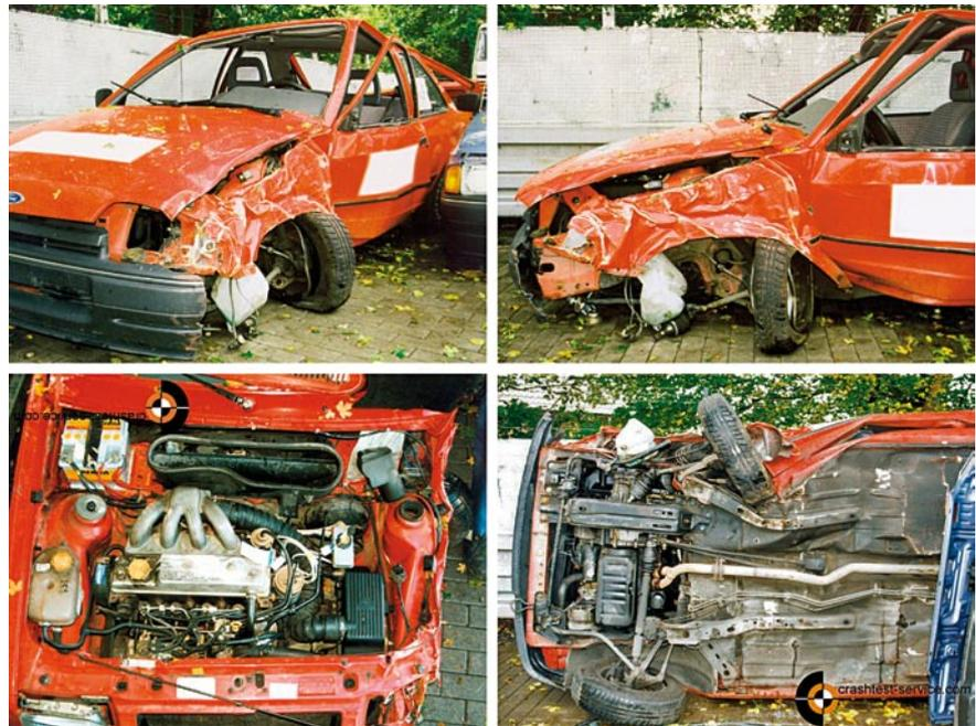
BILD 7: Schäden nach dem 3. Crashversuch,  $v_k = 77$  km/h, EES = 47 km/h
