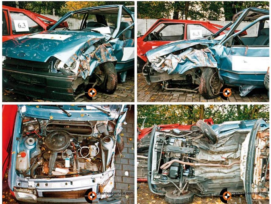
**BILD 6:** Schäden nach dem 2. Crashversuch,  $v_k = 63$  km/h, EES = 48 km/h
