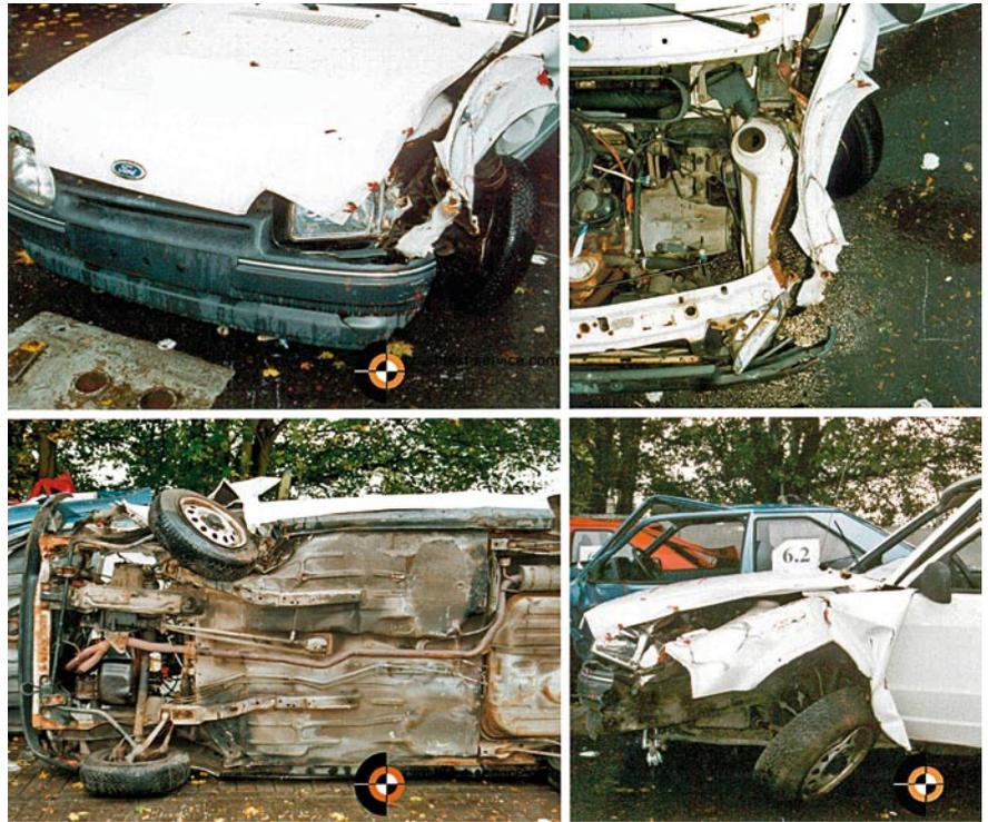
**BILD 5:** Schäden nach dem 1. Crashversuch,  $v_k = 40$  km/h, EES = 37 km/h
