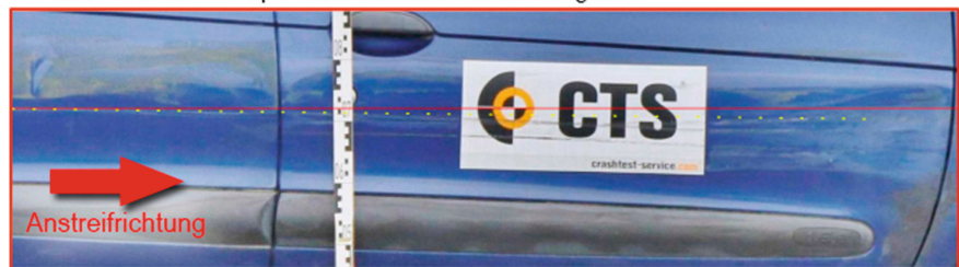
Versuch 2: Abfallende Spur bei Beschleunigung während der Kollision
