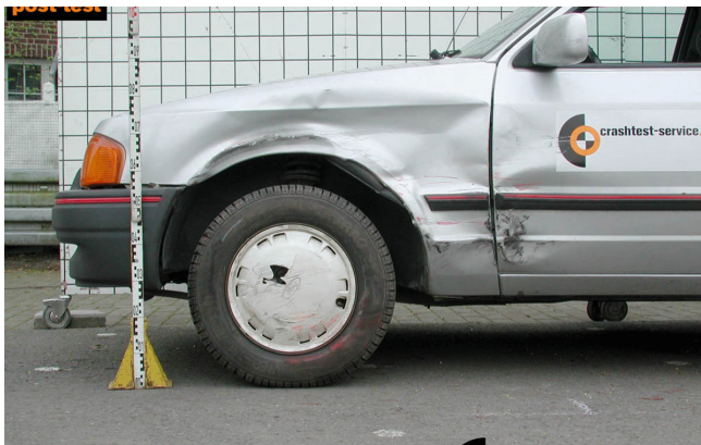
BILD 6: Schadenbild ohne Rampeneffekt
