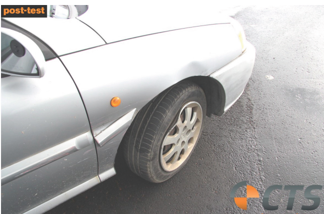
BILD 8: Verdeutlichung der Überdeckung durch dunkle Druckstelle
