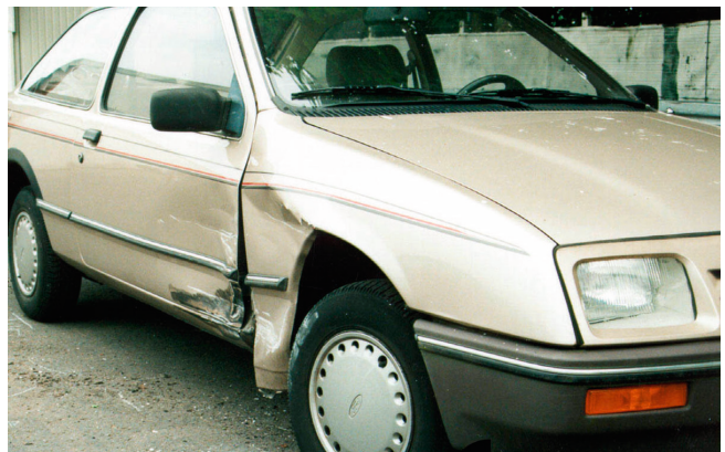
BILD 7: Schadenbild durch den Rampeneffekt
