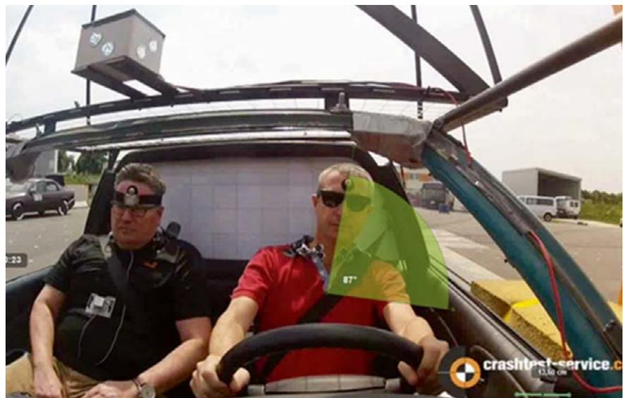
**BILD 3:** In der Frontansicht des Pkw erfolgt für den Fahrer die Berechnung der seitlichen Neigung der HWS (in Grad) relativ zum Sternum und unter Beachtung der Achse der Schultergelenke (y-Achse)
