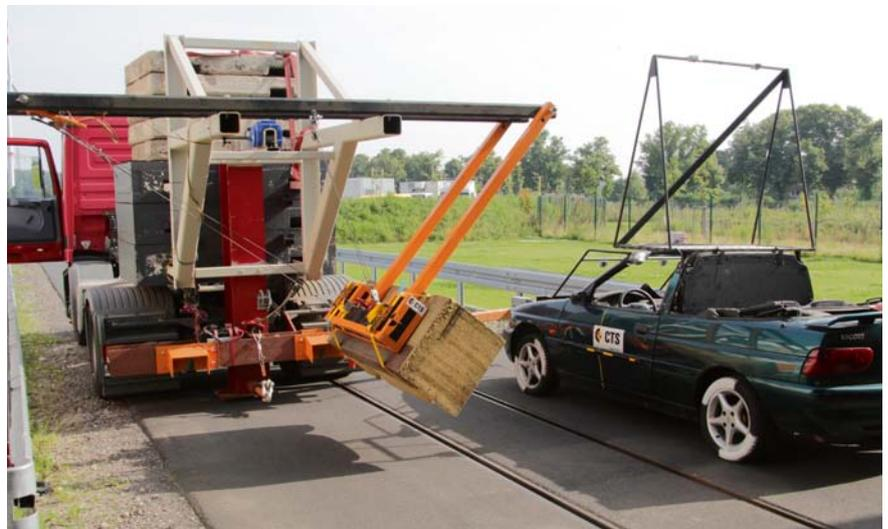
**BILD 1:** Lkw Typ Mercedes Benz Actros mit ausgelenkter Pendelvorrichtung und Pkw Typ Ford Escort Cabrio
