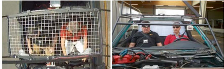
**BILD 2:** „Vogelansicht“ der Videokameras (Typ GoPro Hero 2, 60fps) und rechts „Frontansicht“
