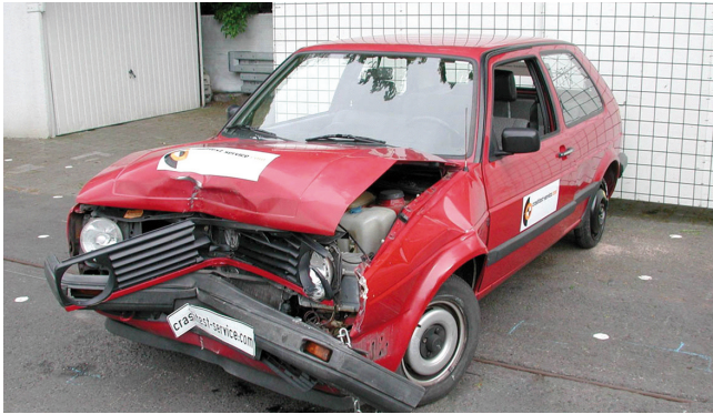
BILD 6: EES-Vergleichsversuch zum Frontschaden (26,6 km/h) FIGURE 6: EES comparative tests (front 26.6 km/h)
