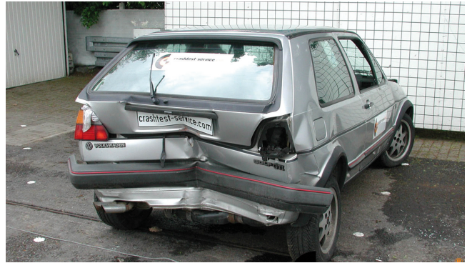
BILD 7: EES-Vergleichsversuche zum Heckschaden (25,2 km/h) FIGURE 7: EES comparative tests (rear 25.2 km/h)
