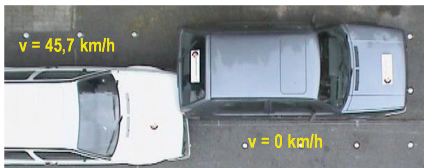
BILD 1: Vergleichsversuch eines versetzten Heckaufpralls zur EES-Schätzung
