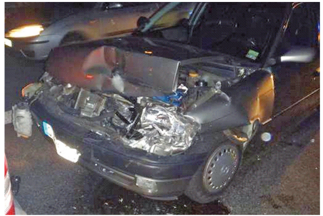
BILD 16: Beschädigungen am auffahrenden Opel Astra FIGURE 16: Damage to the Opel Astra impacting from the rear
