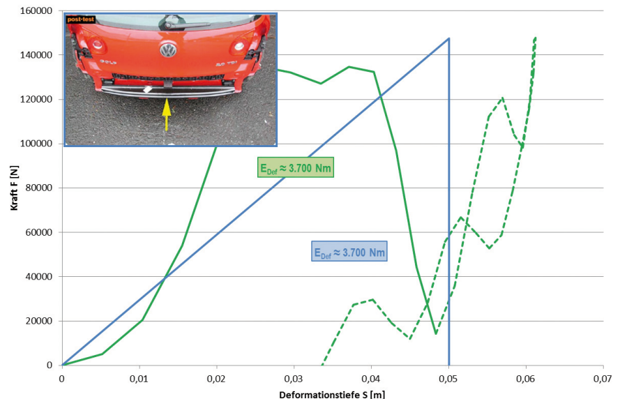
BILD 21: Kraft-Weg-Kennung des Vergleichs-VW-Golf
