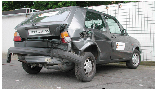
BILD 3: Gestoßenes Fahrzeug (VW Golf II) FIGURE 3: Impacted vehicle (VW Golf II)
