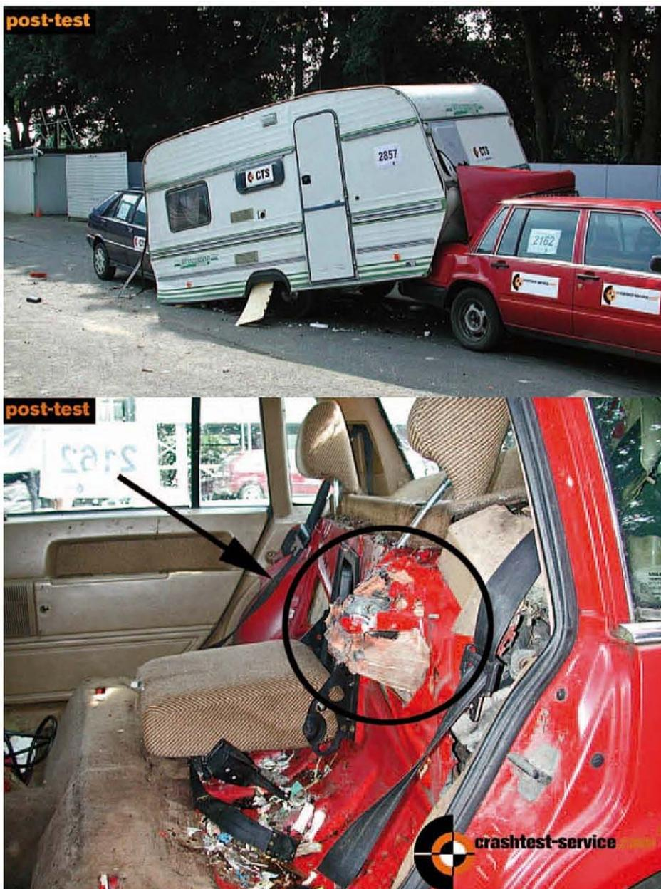
**BILD 2:** Crashversuch (oben); die Anhängerkupplung durchstößt die Rückbank (unten, Kreis)
