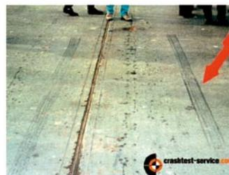
BILD 7: Blockierspurverdickung [1, 2, 5, 6]
