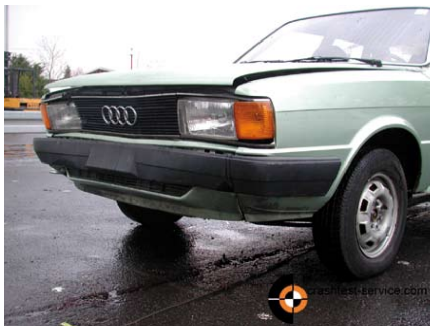
BILD 9: Schäden des Versuchsfahrzeugs
