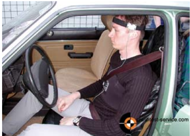
BILD 8: Proband mit Beschleunigungssensoren
