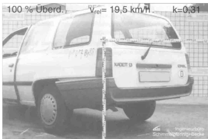
Bild 6 Deformation des gestoßenen Opel Kadett Fig. 6 Deformation of target vehicle
