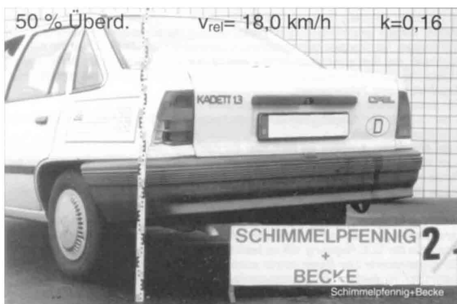
Bild 22 Beschädigung des gestoßenen Opel Kadett Fig. 22 Damage of target vehicle
