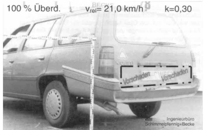
Bild 16 Beschädigung des gestoßenen Opel Kadett Fig. 16 Damage of bullet vehicle
