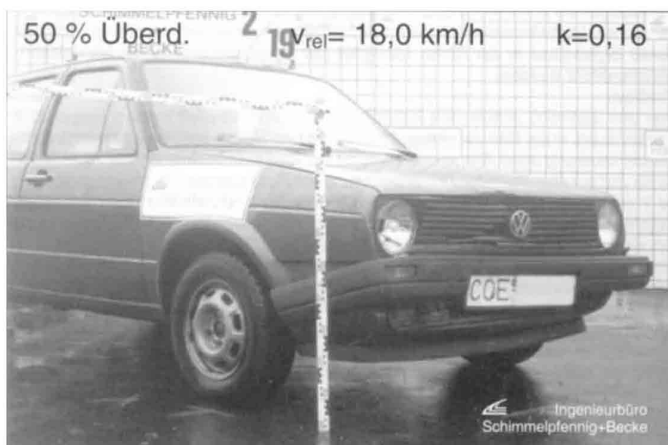
Bild 21 Beschädigung des stoßenden VW Golf Fig. 21 Damage of bullet vehicle
