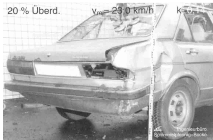
Bild 20 Beschädigung des gestoßenen Audi 80 Fig. 20 Damage of target vehicle
