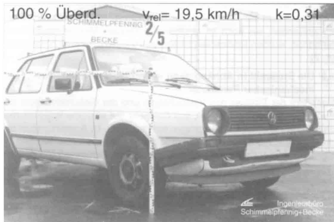
Bild 5 Deformation des stoßenden VW Golf Fig. 5 Deformation of bullet vehicle
