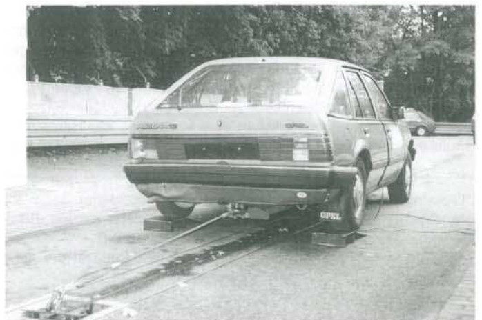
Bild 4 Opel mit Halteseil auf Rampen Fig. 4 Opel hold by a rope of steel at a sloping surface
