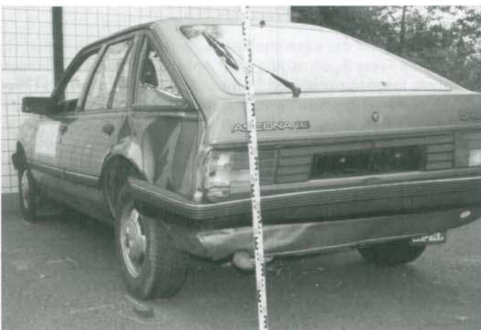
Bild 2 Versuchsschäden ( v_1 | 20 km/h, \Delta v_1 = -9,6 , \Delta v_2 = 13 km/h) Fig. 2 Damages ( v_1 | 20 km/h, \Delta v_1 = -9,6 , \Delta v_2 = 13 km/h)
