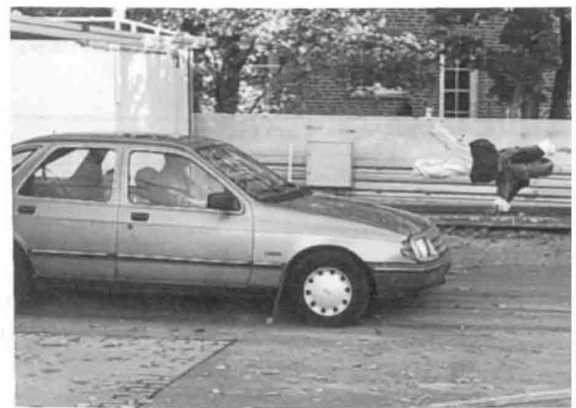
Bild 5 Querwurfweite: 2,20 m Längswurfweite: 9,30 m v_K = 33 \text{ km/h} , v_{\text{Dummy}} = 5,5 \text{ km/h} , \Delta t = \text{ca. } 80 \text{ ms}
