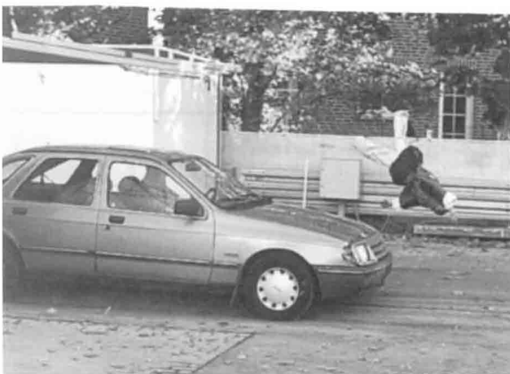
Bild 5 Querwurfweite: 2,20 m Längswurfweite: 9,30 m v_K = 33 \text{ km/h} , v_{\text{Dummy}} = 5,5 \text{ km/h} , \Delta t = \text{ca. } 80 \text{ ms}
