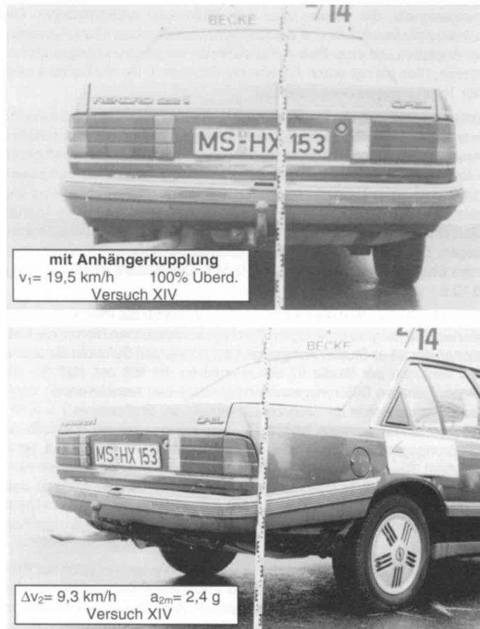
Bild 14 Beschädigungsbilder der Versuchsfahrzeuge mit und ohne Anhängerkupplung
