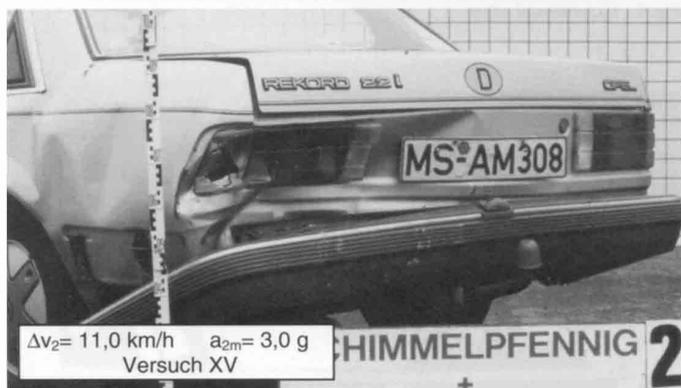
Bild 6 Beschädigungsbilder Versuchsfahrzeuge ( $v_1 = 25 \text{ km/h}$ ,  $\Delta v_2 = 11 \text{ km/h}$ )
