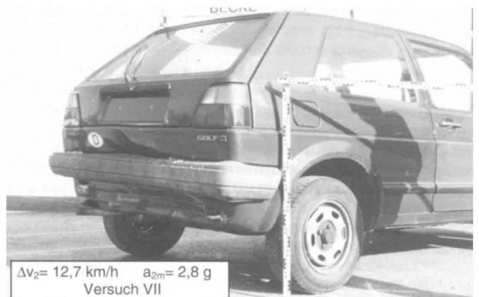
Bild 12 Beschädigungsbilder der Versuchsfahrzeuge (»Stoßfänger-auf-Stoßfänger-Anprall«)
