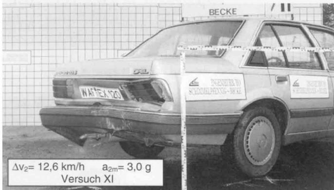
Bild 13 Beschädigungsbilder unterschiedlicher Fahrzeugkonzepte
