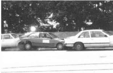
Kollisionsphase: Das mittlere Audi Coupé ist heckseitig stark angehoben und die Front ist eingetaucht.
