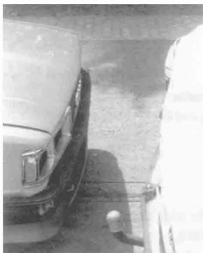
Gewählte Anstoßposition. Die Stoßfängerecke fährt knapp an der Anhängerkupplung vorbei
