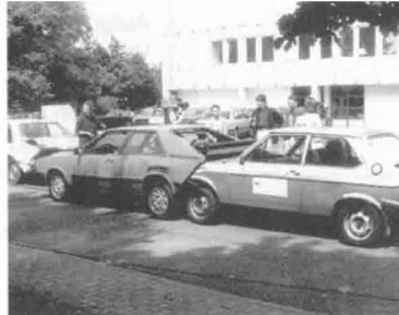
Endpositionen der 3 Fahrzeuge nach dem Crash mit 60 km/h
