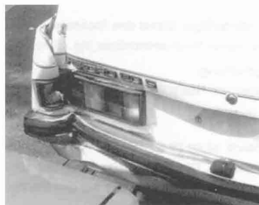
Der vorhandene Altschaden am Opel stammt von einer Mauerecke
