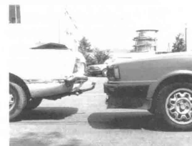
Höhenzuordnung der Fahrzeuge im statischen Zustand. Der Höhenunterschied lag bei 10 cm.
