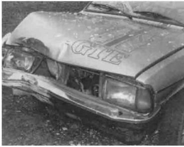
Front des Audi mit vertikaler Kerbe
