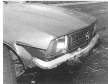
Verformungstiefe an der Front des Opel
