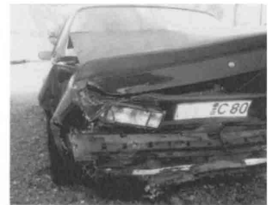
Eindrückung an der linken hinteren Ecke des Opel
