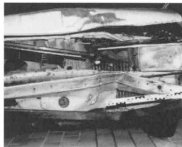
Vertikale Einkerbung an der Front des Audi
