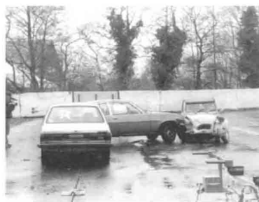
Endstellungen nach dem Crash mit 41 km/h
