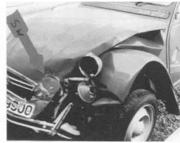
Korrespondierende Abdruckspuren des Scheinwerfers und Stoßfängers am Citroën
