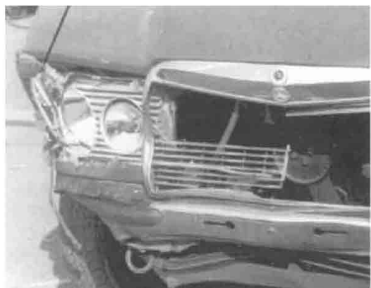
Stark eingedrückter Kotflügel
