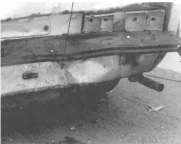
Einkerbung durch DB-Abschleppöse
