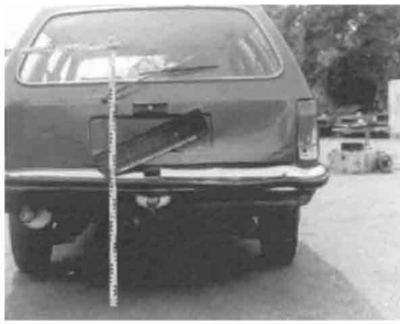
Heckverformungen am Opel Rekord-Kombi
