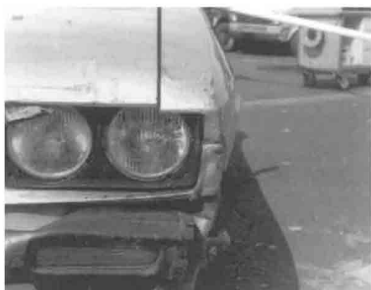
Leichte Verformung an der Kotflügelspitze des Ford Capri
