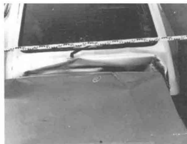
Überdeckung bei Erstkollision mit 53 km/h
