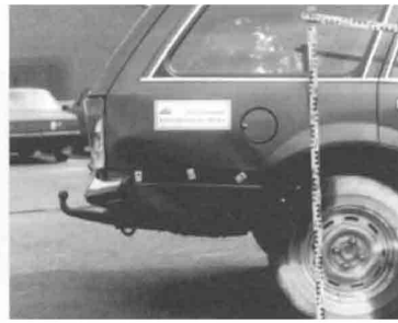
Eindringtiefe am Kombi-Heck. Das Fahrzeug war mit einer Anhängerkupplung ausgestattet.
