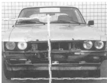
Front des Capri nach Anstoß mit 32 km/h
