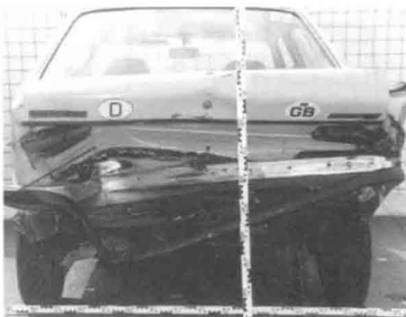
Heck des VW Derby nach Aufprall des Capri
