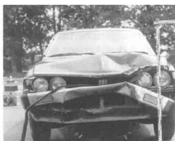
Verformungen an der Front des Mitsubishi
