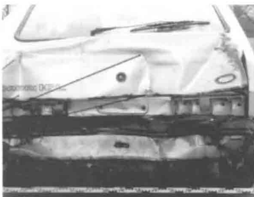
Heck des Capri nach DB-Aufprall
