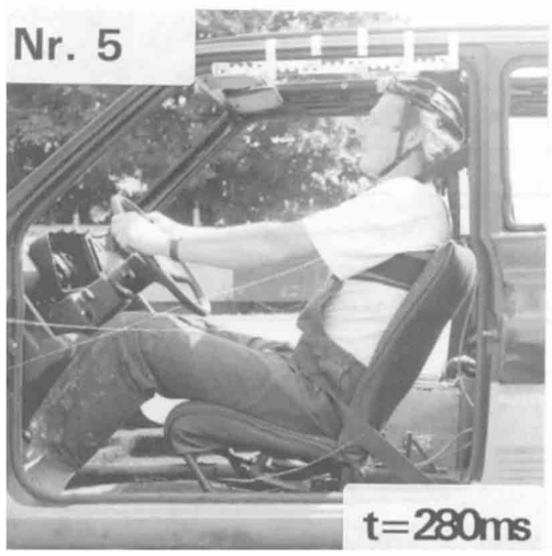
Bild 2 Bildsequenz der Insassenbewegung nach einem Lkw-Heckanstoß
