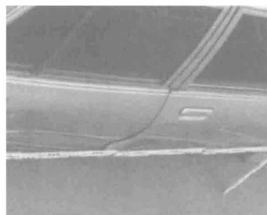
Übersichtsaufnahme des Verformungsverlaufs
