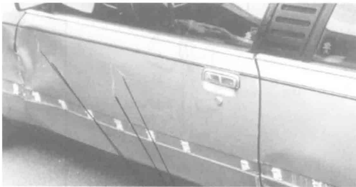
Bild 2 An dem seitlich gestreiften Fahrzeug liegen sehr ungewöhnliche, senkrecht verlaufende Kratzspuren vor
