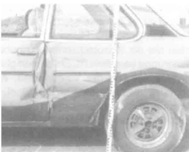
Deformationen in Höhe der B-Säule
