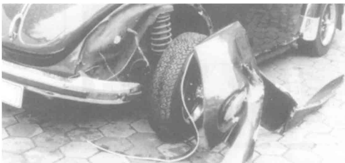
Bild 3 Die Besichtigung des zweiten Fahrzeugs zeigt, daß diese senkrechten Kratzspuren vom abgerissenen Kotflügel stammen, also kompatibel sind
