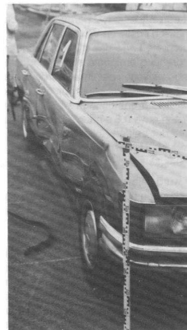
Bild 9 Deformation am gestoßenen Mercedes beim Einbiegeversuch Fig. 9 Deformation of the struck Mercedes in test with turn-in
