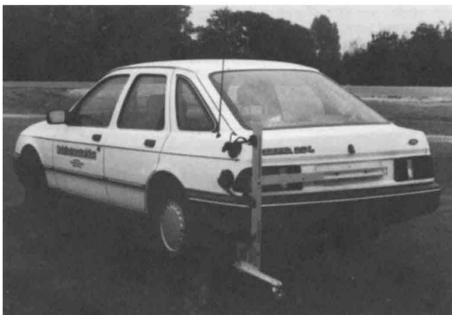
Bild 6 Messung des Wankverhaltens Fig. 6 Measuring the degree of rolling
