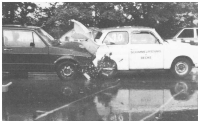
Bild 1 VW-Golf 44 km/h, 100% Überdeckung auf das Heck des stehenden Trabant
