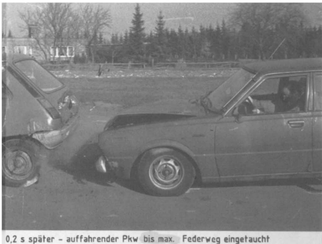
Bild 12 Höhenverschiebung bei einem Auffahrunfall
