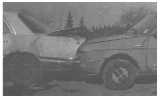
Bild 9 Auswirkungen unterschiedlicher Front- und Hecksteifigkeiten auf die Eindringtiefe (Fotoaufnahme während Kollision)
