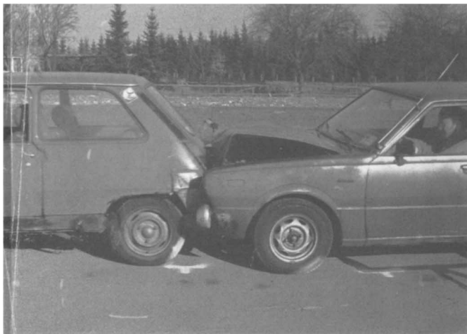
Kollisionsphase - auffahrendes Fzg. stark gebremst
