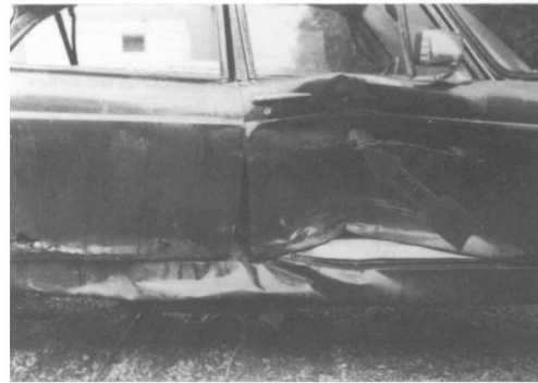
Bild 5 Nach seitlichem Türaufprall entsteht markante Beule am Kotflügelende durch den in der glattflächigen Tür »versteckten« Scheibenmotor
