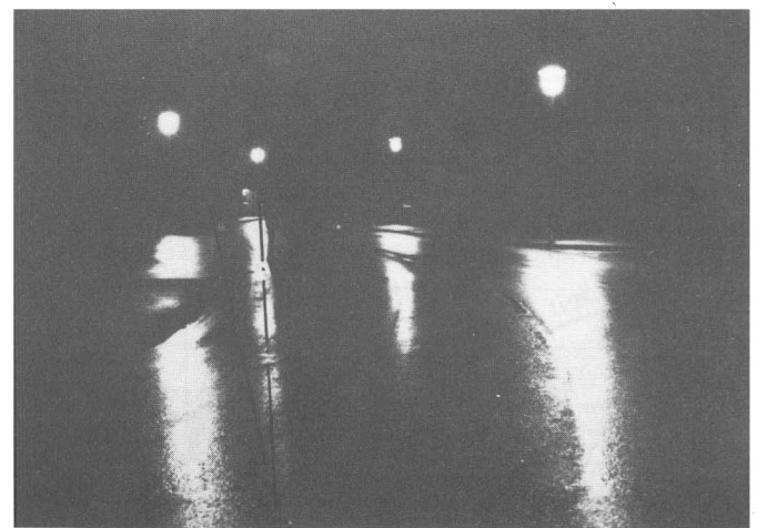
Bild 2 Wanderung der Glanzstreifen bei Annäherung
