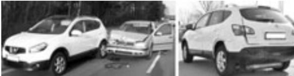
Der vorliegende Fall zeigt eine Heckkollision zwischen einem Nissan Qashqai und VW Golf. Die ermittelte kollisionsbedingte Geschwindigkeitsänderung im Nissan Qashqai betrug etwa 15 km/h.
