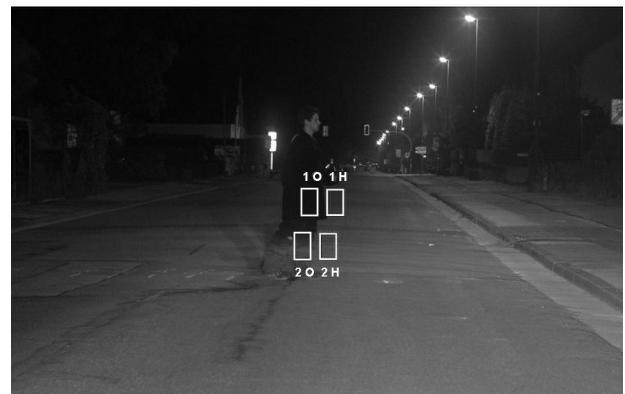
Aus der Differenz der Leuchtdichte des Objekts zum Hintergrund wird durch den Vergleich mit experimentellen Untersuchungen von Berek und Adrian, eine quantitative Aussage zur Sichtbarkeit möglich. Wurden mehrere Bilder bei abnehmendem Abstand zum Fußgänger aufgenommen, kann die Erkennbarkeitsentfernung sehr anschaulich in einem SI-Diagramm (Sollwert - Istwert-Diagramm) dargestellt werden. Dort, wo die Istwertkurve die Sollwerte schneidet, ist der Fußgänger erstmalig erkennbar.
