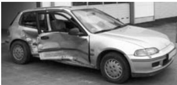
Nach der rechnerischen Analyse und einem durchgeführten Versuch stellte sich heraus, dass der PKW seitlich mit einer Geschwindigkeit von 50 km/h getroffen wurde, woraus eine kollisionsbedingte Geschwindigkeitsände-
