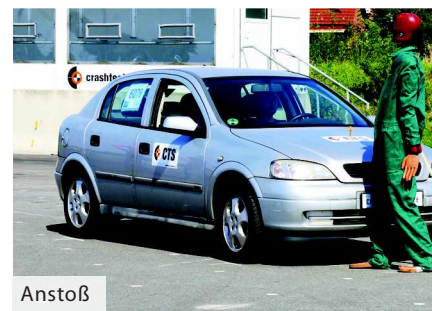
BILD 3: CTS – Crashversuch mit 32 km/h
