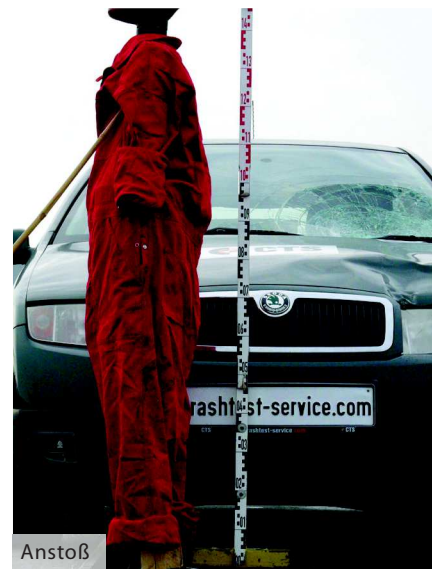
BILD 2: CTS – Crashversuch mit 37 km/h
