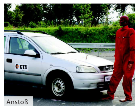
BILD 4: CTS – Crashversuch mit 28 km/h
