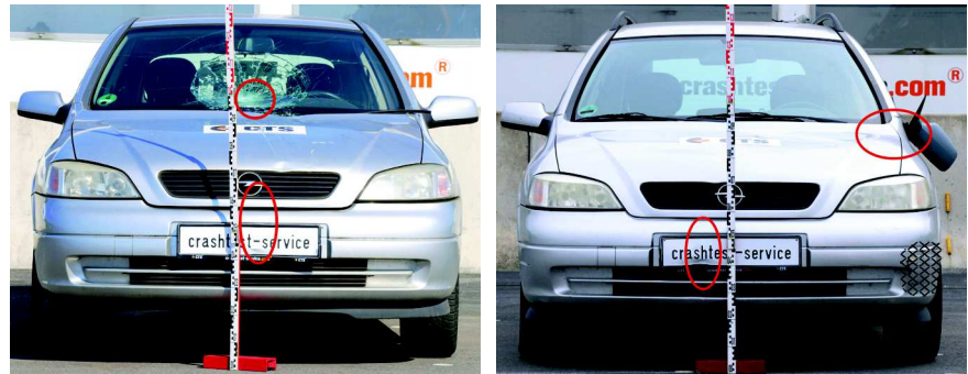
BILD 5: CTS – Crashversuch: Vergleich des Beulenversatzes aus Bild 3 und Bild 4 FIGURE 5: CTS – crash test: comparison of the dent pattern from Figure 3 and Figure 4
