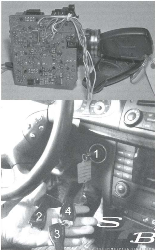
Abb.2: Analyse eines elektronischen Zündschlosses einer Oberklasselimosine (oberes Bild), Starten des Versuchsfahrzeugs mit vier Schlüsseln unterschiedlicher Bauart (unteres Bild).
